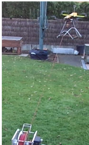
**Le drone filaire ( tethered drone)**, peut être une alternative aux pylônes et vous permettre de pratiquer la DATV.
